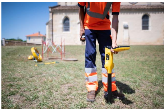
Figure 1 : Détecteur électromagnétique Vivax vLocPro3
